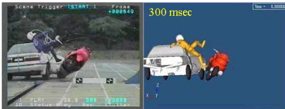
Figura 3: Confronto tra crash-test reale e simulazione FEM
